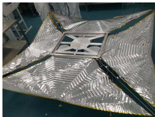
Figura 4: La vela per il satellite Techdemosat-1. [7].
