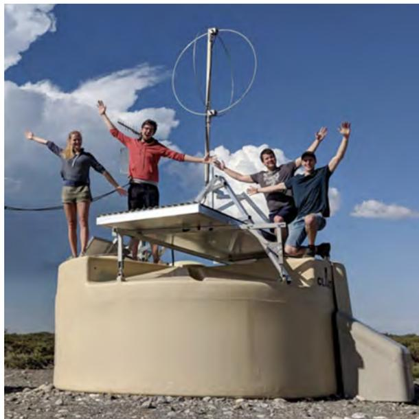
Figura 15: Uno dei rivelatori di superficie di AugerPrime. Sono visibili sia il rivelatore a scintillazione (4 m<sup>2</sup>) che l'antenna radio installati sopra la stazione Čerenkov.
