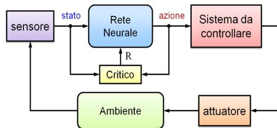
**Figura 13:** Paradigma di apprendimento con rinforzo. La rete neurale genera delle azioni di controllo su un sistema che interagisce con l'ambiente e riceve da un critico una valutazione ( $R$ ) sulla loro efficacia. Lo scopo dell'apprendimento con rinforzo è di imparare a generare azioni che migliorino la valutazione del critico.
