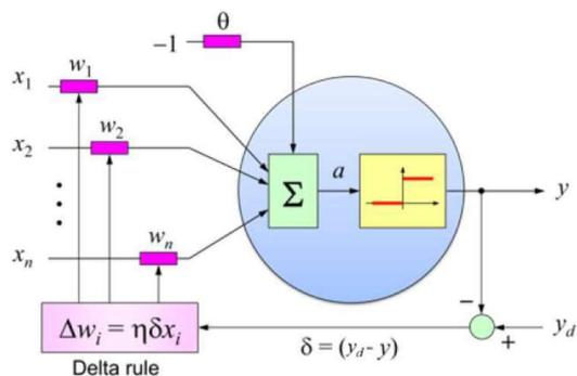
**Figura 4:** Il Perceptron di Rosenblatt. Durante la fase di apprendimento, i pesi vengono modificati in funzione dell'errore ( $\delta$ ) commesso dal neurone, pari alla differenza tra l'uscita desiderata ( $y_d$ ) e quella reale ( $y$ ).
