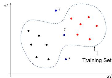
**Figura 11:** Problema della classificazione nel paradigma di apprendimento supervisionato. I punti colorati rappresentano gli esempi del training set descritti da due variabili ( $x_1, x_2$ ): i punti rossi appartengono ad una classe A, i punti neri no. Terminato l'apprendimento, nella fase di inferenza la rete deve stabilire se dei nuovi dati (i punti blu) appartengono o meno alla classe A.
