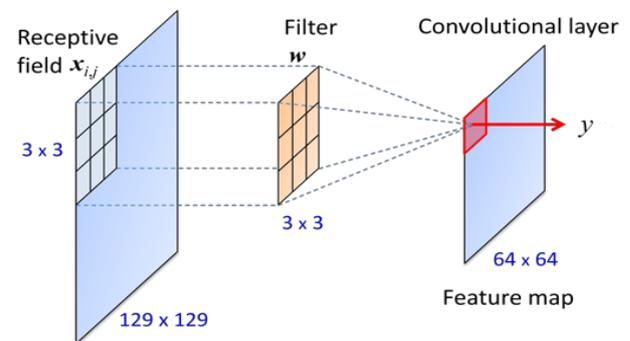
**Figura 15:** Operazione di convoluzione elementare in una rete convoluzionale. Il valore  $y$  del neurone in rosso è calcolato come la somma dei prodotti tra i valori dei neuroni del campo recettivo  $x$  e i pesi del filtro  $w$ , i.e.  $y = \mathbf{x}_{i,j} * \mathbf{w} = \sum_{l=1}^r \sum_{m=1}^r x_{i+l,j+m} w_{lm}$ .
