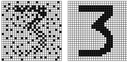
**Figura 5:** Esempio di memoria associativa realizzata mediante una rete di Hopfield: (a) immagine presentata come stato iniziale; (b) immagine recuperata, corrispondente ad uno stato stabile memorizzato in precedenza. Ogni pixel corrisponde ad un neurone. In questo esempio la rete ha 784 neuroni per rappresentare immagini binarie di  $28 \times 28$  pixel.
