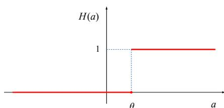
**Figura 3:** Funzione di Heaviside, utilizzata come funzione di uscita nel neurone binario a soglia.
