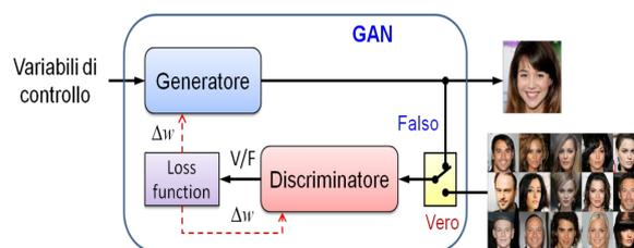
**Figura 16:** Architettura di una rete GAN. Il Generatore ha il compito di produrre campioni falsi realistici, mentre il Discriminatore ha il compito di distinguere i campioni autentici (provenienti dal database) da quelli falsi prodotti dal Generatore. Gli errori commessi da ciascuna rete contribuiscono al miglioramento di entrambe.
