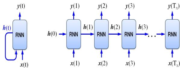
**Figura 14:** Struttura di una rete ricorrente in cui l'uscita dello strato nascosto  $h(t)$  viene riportata in ingresso (a). La figura (b) illustra la versione unrolled in cui sono evidenziati i valori dei vettori per i vari istanti temporali.
