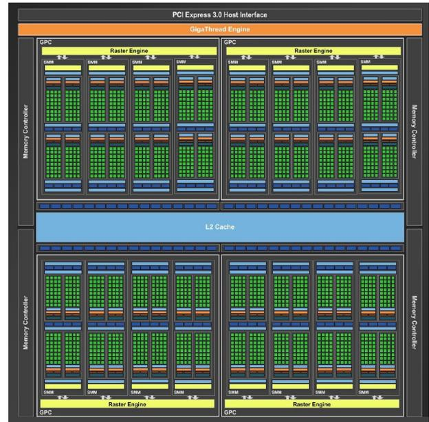
Figura 10: Architettura Maxwell
