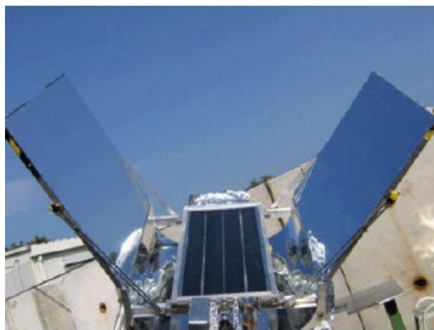
Figura 4: Un'immagine del collettore solare ad ultra-alto vuoto a schermo piatto realizzato al CERN impiegando diverse tecniche sviluppate per LHC e pienamente commercializzato (ad esempio l'impianto di 1200 metri quadri realizzato all'aeroporto di Ginevra).
