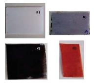
Fig.1 Pure polyethylene (a), Polyethylene + C16H18N3SCl (b), Polyethylene + CNT (c), Polyethylene +Fe2O3, (d)
